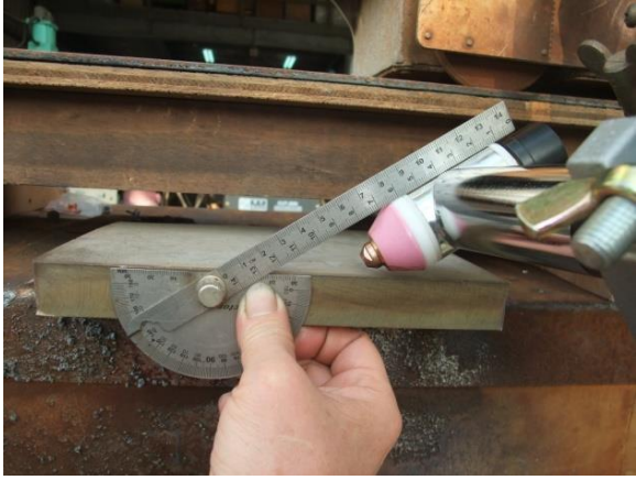
圖 39. 漏溝角度與高度
