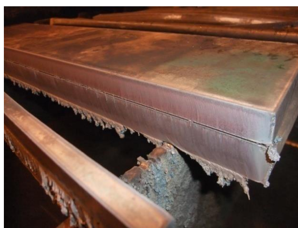
交機驗貨，以 30mm 及右邊相疊成 60mm 測試切割能力
