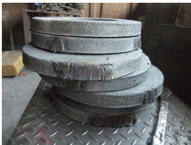
磨邊後的切割品準備進入車床精密加工
