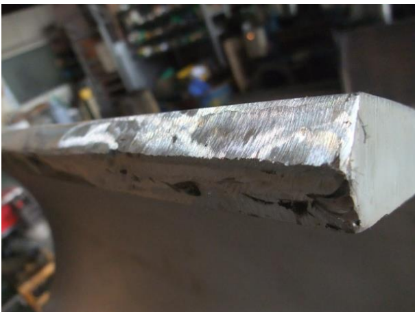
空氣電漿切割不易整理斷面成可銲接工作
