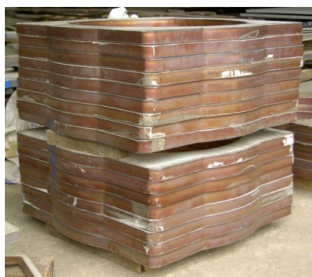
混合氣電漿切割 30mm 不銹鋼成品，外表呈金黃紅色澤
