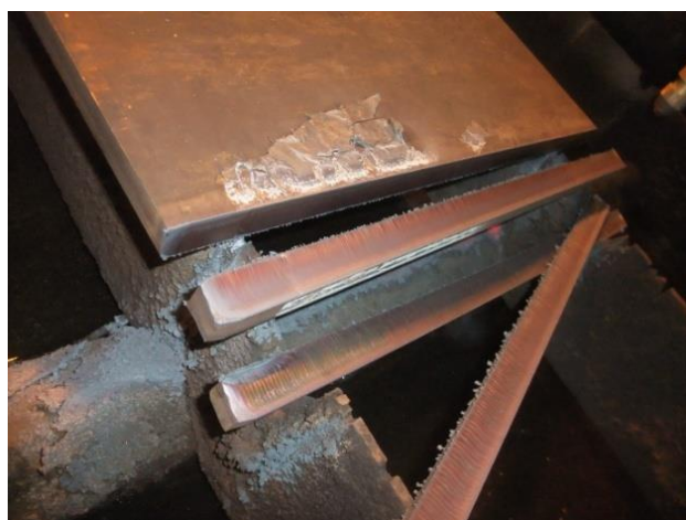
交機驗貨，以 30mm 及右邊相疊成 60mm 測試切割能力
