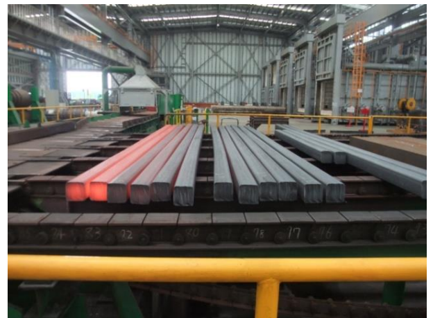
圖 33. 切割物輸送，準備集中進入退火爐
