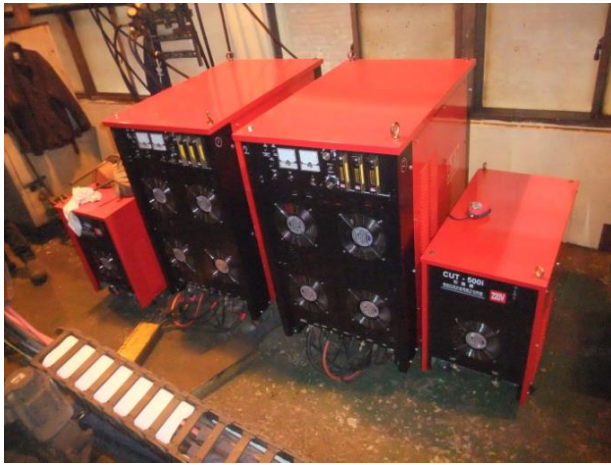
盛全混合氣電漿切割機 CUT-500i x2 的實況
