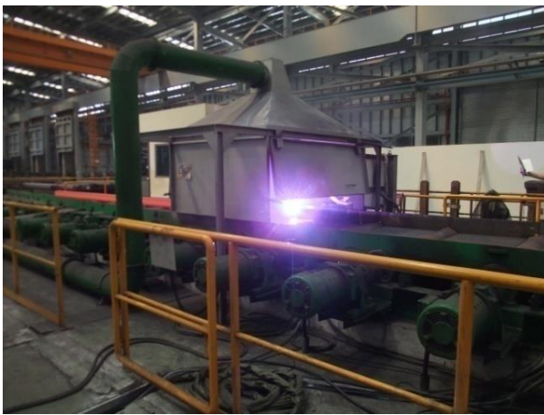
圖 32. 電切站切割實況
